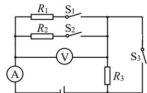
D. 开关  $S_1$ 、 $S_2$  和  $S_3$  都闭合时，电路消耗的总电功率最大
