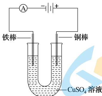
现象:电流表指针偏转,铜棒变细,铁钉表面覆盖一层红色的铜。
